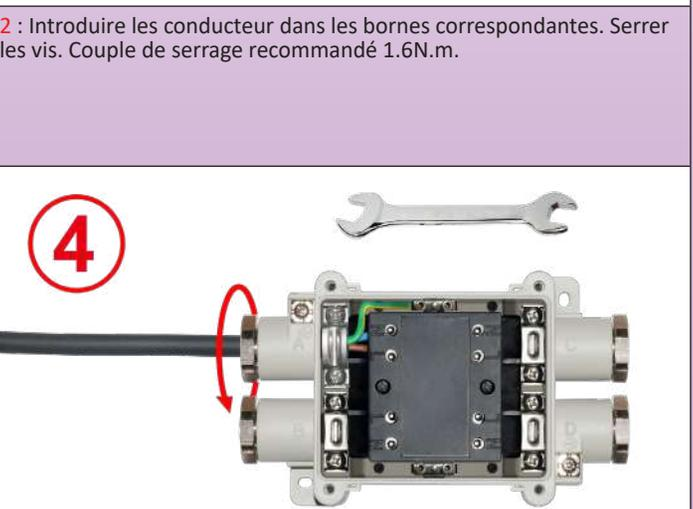
**4** : Faites glisser la garniture du câble rond dans le presse étoupe puis serrez l'écrou. Couple de serrage maximum 3N.m.
