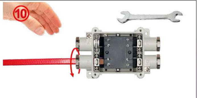
**10** : Faire glisser la garniture du câble méplat dans le presse étoupe puis serrer l'écrou. Couple de serrage maxi 3N.m. Si ce n'est pas encore fait procéder aux raccordement de l'autre câble et refermer le couvercle.
