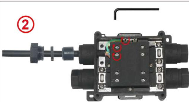
**2** : Introduire les conducteurs dans les bornes correspondantes. Serrer les vis. Couple de serrage recommandé 1.6N.m.
