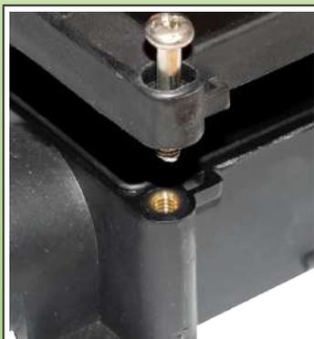
**1** : Quatre vis en acier inoxydable imperdables serrant sur des inserts métalliques. Pas de vissage dans la matière plastique, pas de charnières fragiles.
