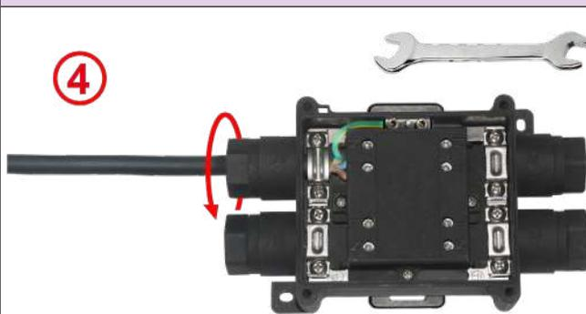
**4** : Faites glisser la garniture du câble rond dans le presse étoupe puis serrez l'écrou. Couple de serrage maximum 3N.m.
