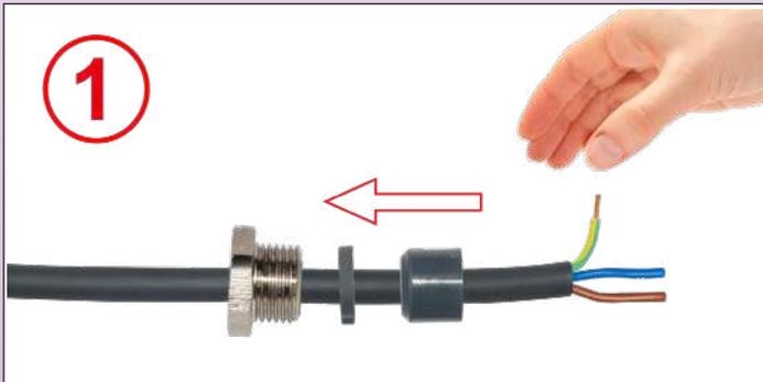
**1** : Dégainer le câble sur 24mm puis dénuder les conducteurs sur 10mm. Eventuellement y installer un soulier de câble. Introduire sur le câble l'écrou de presse-étoupe puis selectionner la garniture d'étanchéité du diamètre compatible et la glisser sur le câble.
