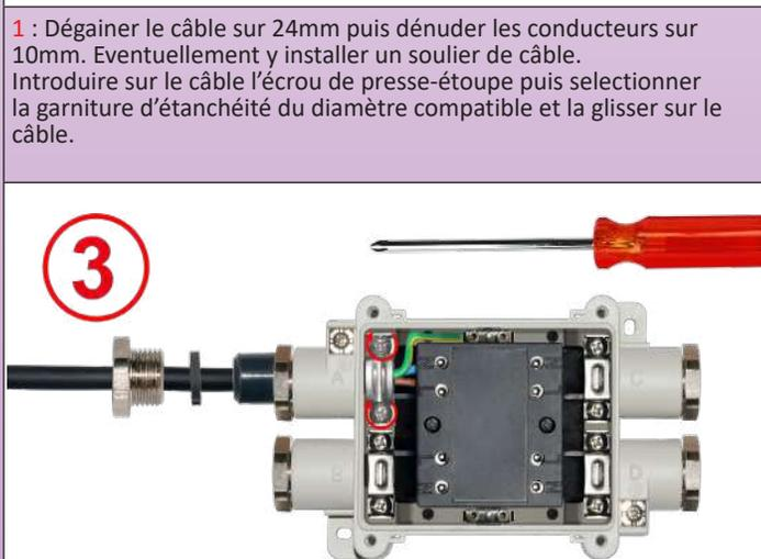
**3** : Placez l'étrier anti-arrachement et ses deux vis sur la câble, et serrez les vis. Couple de serrage recommandé 1.6N.m pour les 3 vis.
