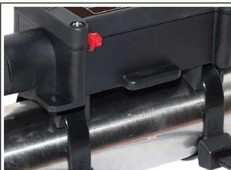
**2** : Deux pattes amovibles pour montage sur tuyauterie, décalant le boîtier de 10mm de la paroi du tube. Idéales et économiques pour les applications avec épaisseur faible d'isolation et température de tuyauterie inférieure à 100°C. Serrage sur tuyauterie métal ou PVC par serre-câble nylon ou collier de serrage métal (Ces pattes sont livrées en standard).
