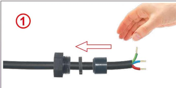
**1** : Dégainer le câble sur 24mm puis dénuder les conducteurs sur 10mm. Eventuellement y installer un soulier de câble. Introduire sur le câble l'écrou de presse-étoupe puis sélectionner la garniture d'étanchéité du diamètre compatible et la glisser sur le câble.
