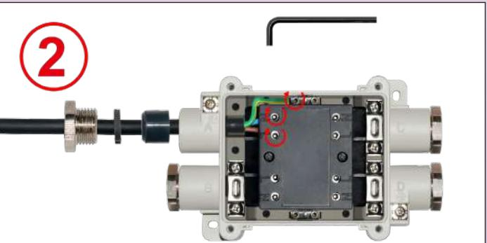
**2** : Introduire les conducteur dans les bornes correspondantes. Serrer les vis. Couple de serrage recommandé 1.6N.m.
