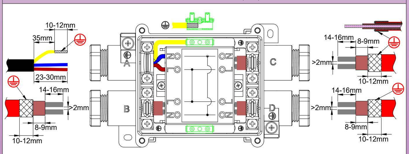
Modèle à 3 câbles chauffants et un câble d'alimentation (Y414)
